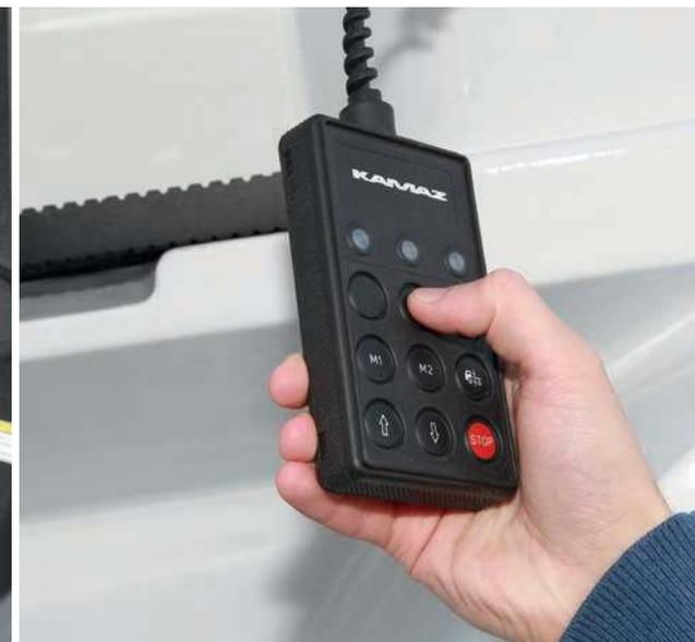
Пульт управления задней пневмоподвеской с кабины
